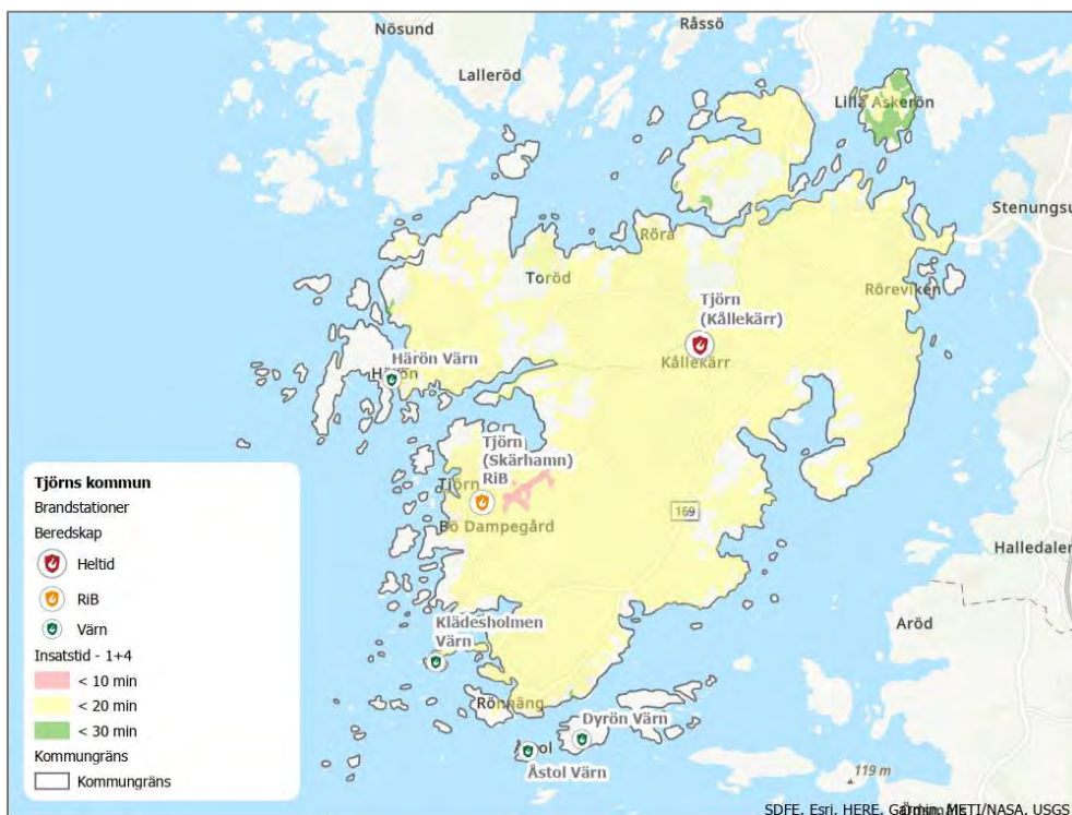
Figur 21. Insattid 10, 20 och 30 minuter för 1+4 på skadeplats. Körtidsanalysen är skapad i ArcGIS Pro enligt ESRI:s körtidsmodell.
